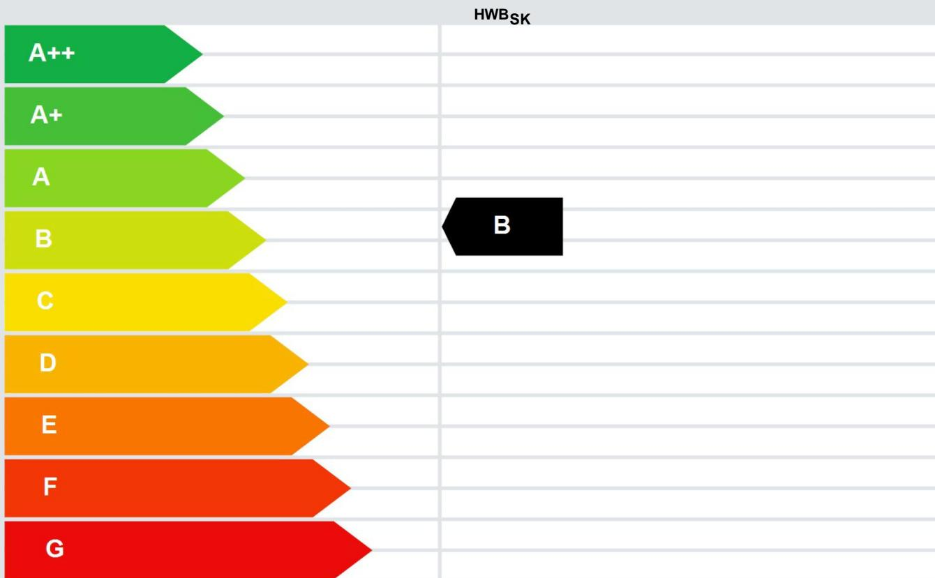
**HWB:** Der **Heizwärmebedarf** beschreibt jene Wärmemenge, welche den Räumen rechnerisch zur Beheizung zugeführt werden muss.
